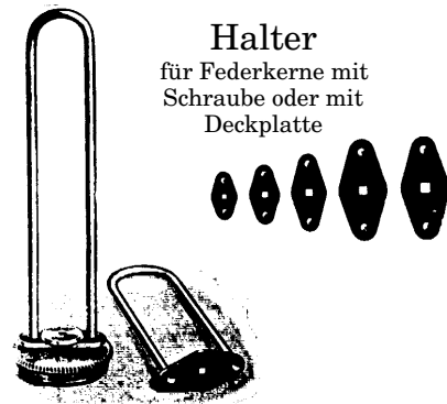
Abb. 6: Federhaus-Halter zur Prüfung der Abwicklung
