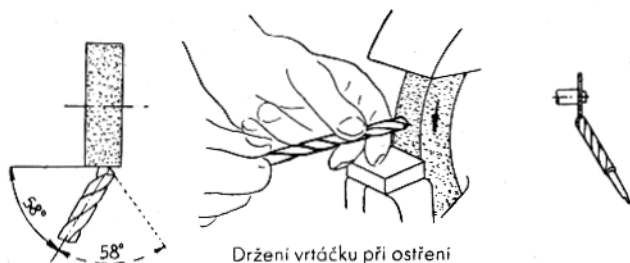
Obr. 338—339. Ostření šroubovitých vrtáků.
