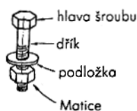
Obr. 217—218. Šroub s hlavou a závrtný šroub.
