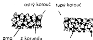
Obr. 332. Ostrý a otupený brusný kotouč. Pojivo je keramické.
