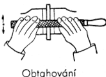
Obr. 67—68. Pilování oblých částí a obtahování (hlazení).
