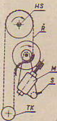
Obr.41. Použití řetězového převodu k natahování hodinového stroje
