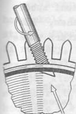
Obr. 39 - Oprava ulomeného háčku v perovníku
