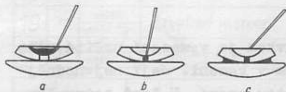
Obr. 52 - Olejová ložiska a - závada; b, c - postup
