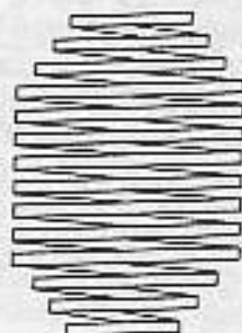
Obr. 14 - Kuželoválčový vlásek Motelův
