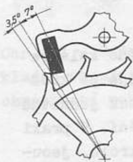
Obr. 79 - Úhel z původní polohy prostřednictvím vodítka, na popudu zubu a palety jehož popudný kámen působí vidlice.
