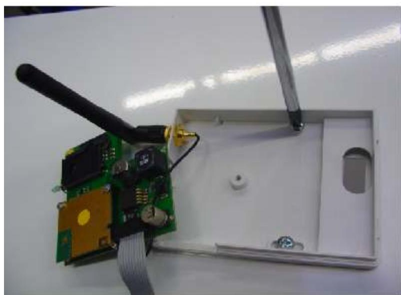
Plastovou krabičku přišroubujte dvěma šrouby do připravených otvorů v krytu kotla. Krabička musí být otočena tak, aby LED dioda po smontování směřovala k obsluze.
