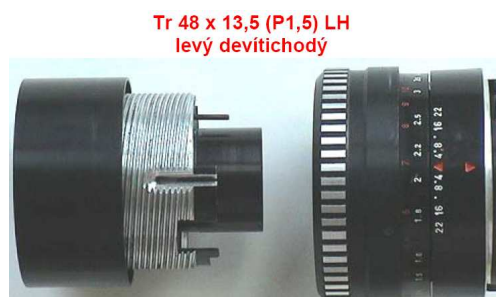
Obr. 2.37 Pohybový závit objektivu fotoaparátu (25)
