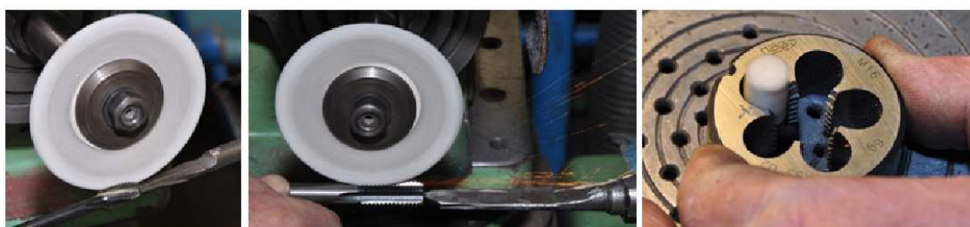
a) b) c) Obr. 4.17 Broušení a) závitník se šroubovými drážkami, b) s přímými drážkami, c) závitová čelist
