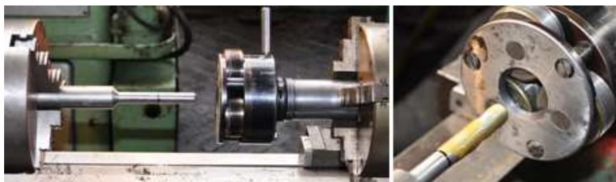
Obr. 4.40 Válcování na univerzálním soustruhu
