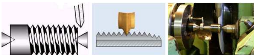
Obr. 4.7 Broušení jednoprofilovým kotoučem (9,17)
