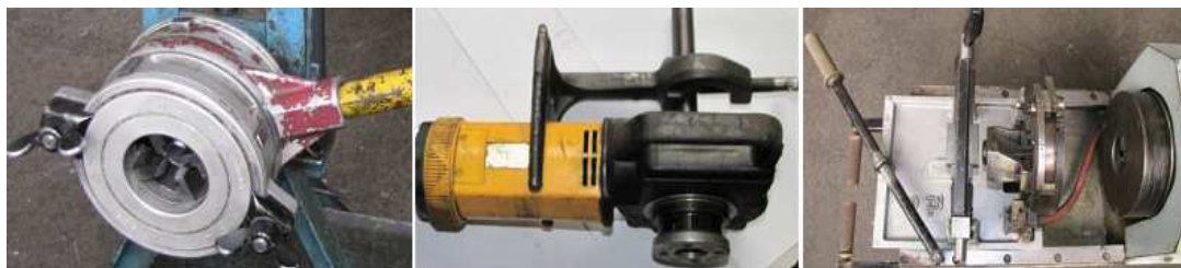
a) b) c) Obr. 4.18 Závitorezná hlava, a) ruční, b) elektrická, c) závitový stroj
