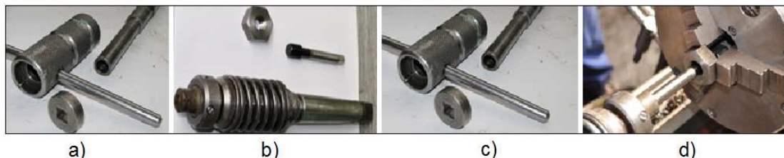
Obr. 4.20 Řezání závitů a) pevné držení závitníku, b) pérová hlava, c) držení kruhové čelisti, d) řezání pomocí pérové hlavy
