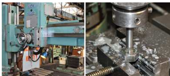
Obr. 4.24 Řezání na vrtačce
